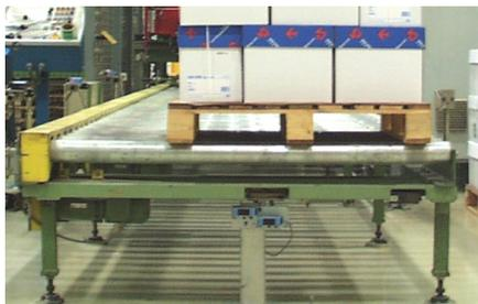
Figura 8 – Sistema de sincronismo de transportadores/AGVs..
